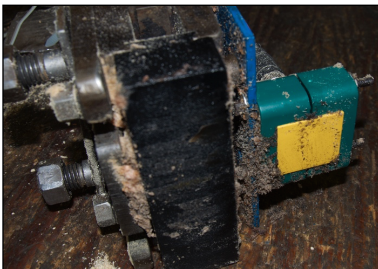
Figura 52 - Detalhe do conjunto guia e sensor após 8 horas de uso contínuo
