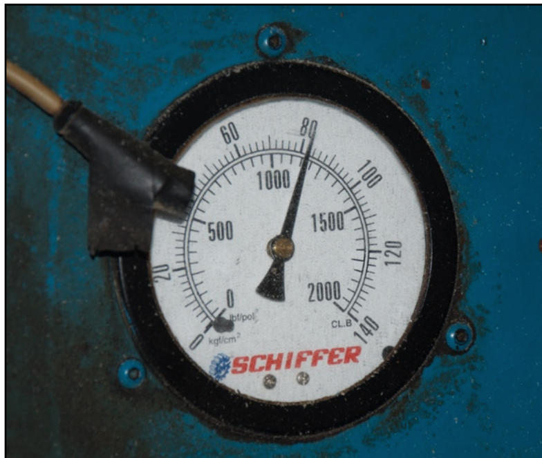
Figura 36 - Manômetro do macaco hidráulico de estiramento da serra
