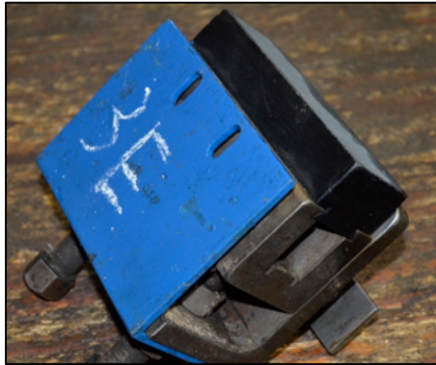
Figura 30 - Conjunto da guia de pressão completo e o suporte para o sensor adaptado
