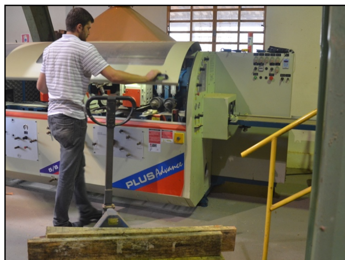
Figura 47 - Plaina moldureira S4S para o aplainamento da madeira
