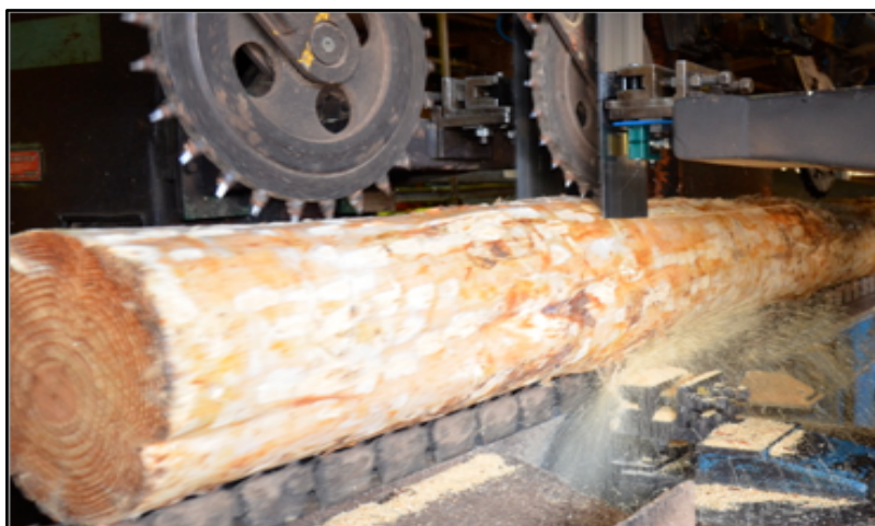
Figura 37 - Serramento da tora de Pinus spp no ambiente industrial
