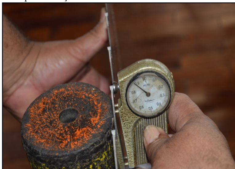
Figura 35 - Dispositivo para medição da altura e simetria do dente
