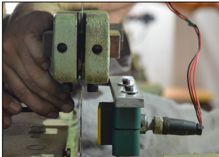
Figura 13 - Guia convencional utilizada nos experimentos de laboratório
