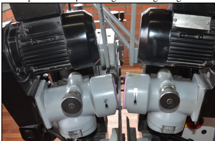
Figura 24 - Equipamento para retificação do ângulo de folga tangencial e axial
