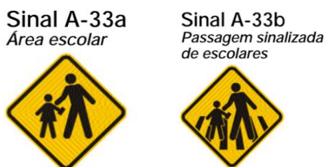
Figura 70 - Sinalização vertical de proximidade de escolas
