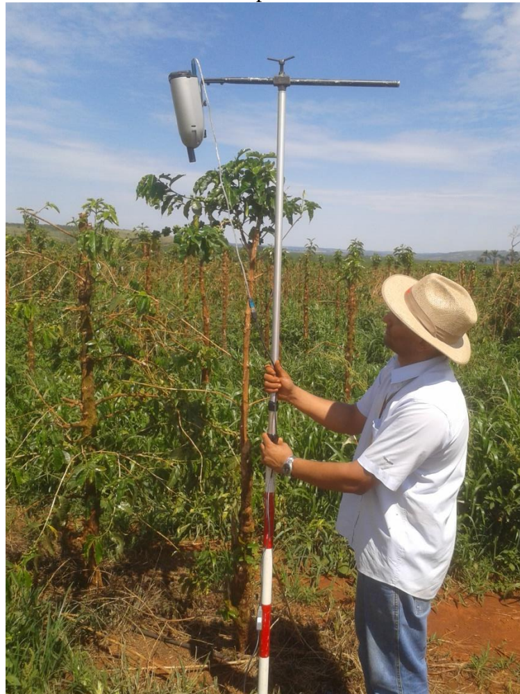
Figura 21. Sistema de aquisição de medidas de FRHC, em culturas cafeeiras, utilizado na coleta dos dados espectrorradiométricos.
