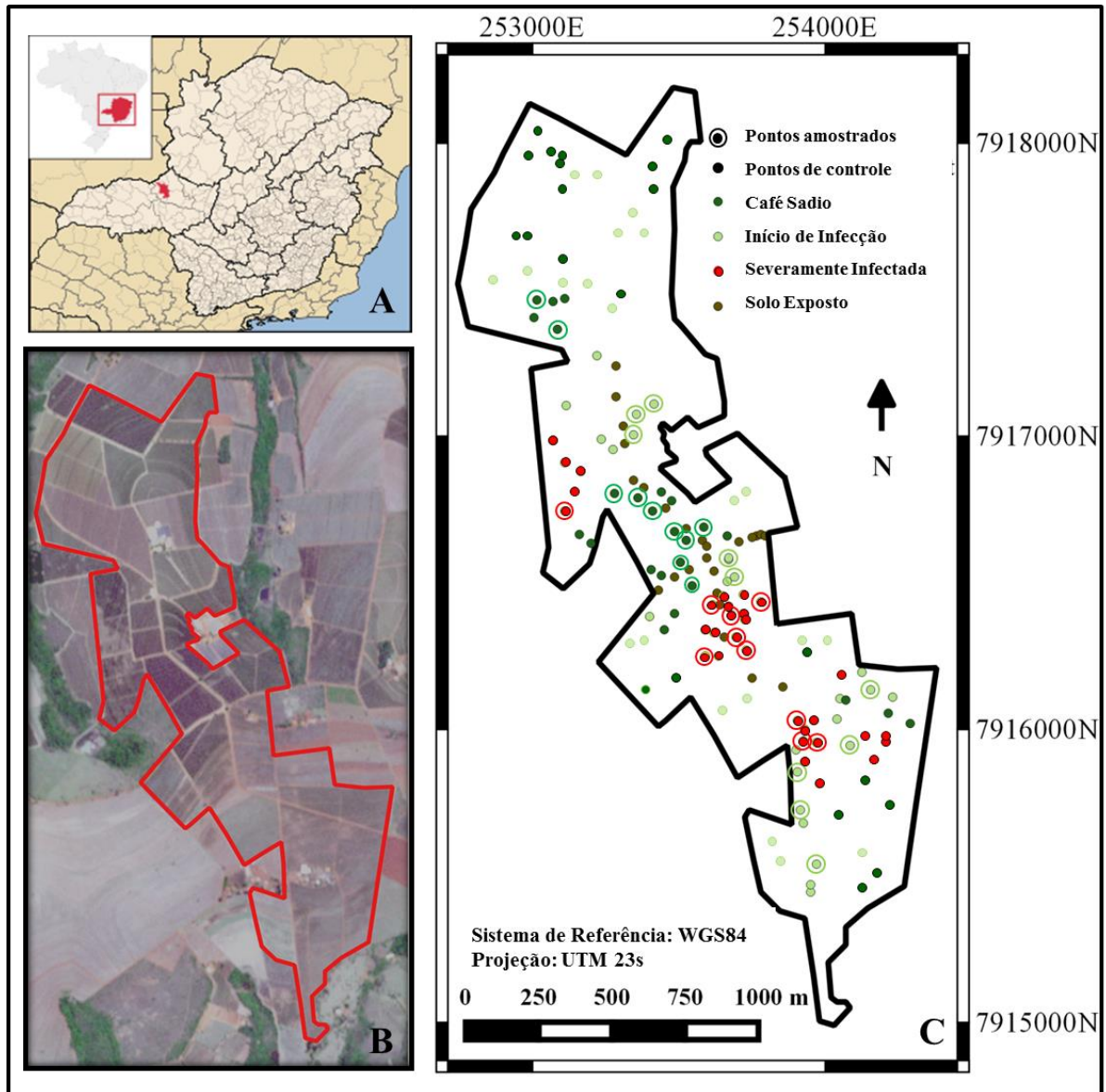
Figura 7. Caracterização da área experimental 1. (A) Município de Monte Carmelo em destaque nos mapas de Minas Gerais e Brasil. (B) Talhões de café destacando a área de estudo em uma composição cor natural RGB da imagem RapidEye, limitada no vermelho. (C) Distribuição espacial de pontos amostrais georreferenciados: círculos representam a localização dos pontos em que folhas do cafeeiro foram extraídas para realizar medições biofísicas e espectrorradiométricas; demais pontos (controle) indicam elementos amostrais usados na estimativa da acurácia.
