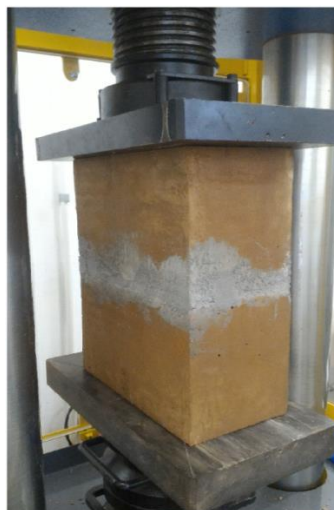
Figura 34- Ensaio de determinação de resistência do prisma
