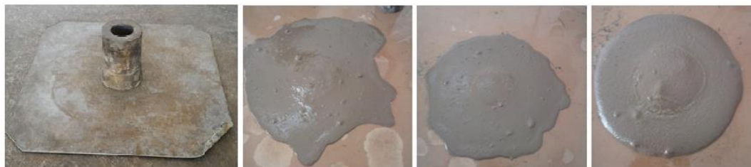
Figura 35- Ensaio de espalhamento preliminar do traço 1
