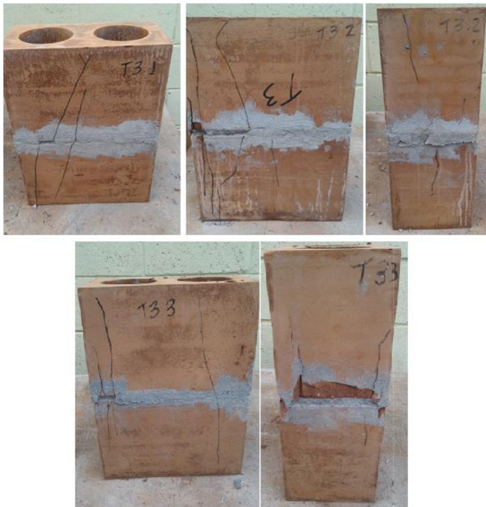
Figura 59- Fissuras características dos prismas – traço 3
