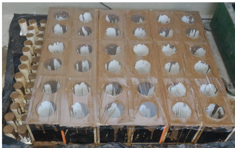
Figura 20- Blocos moldados em formas de madeira e furos em PVC.
