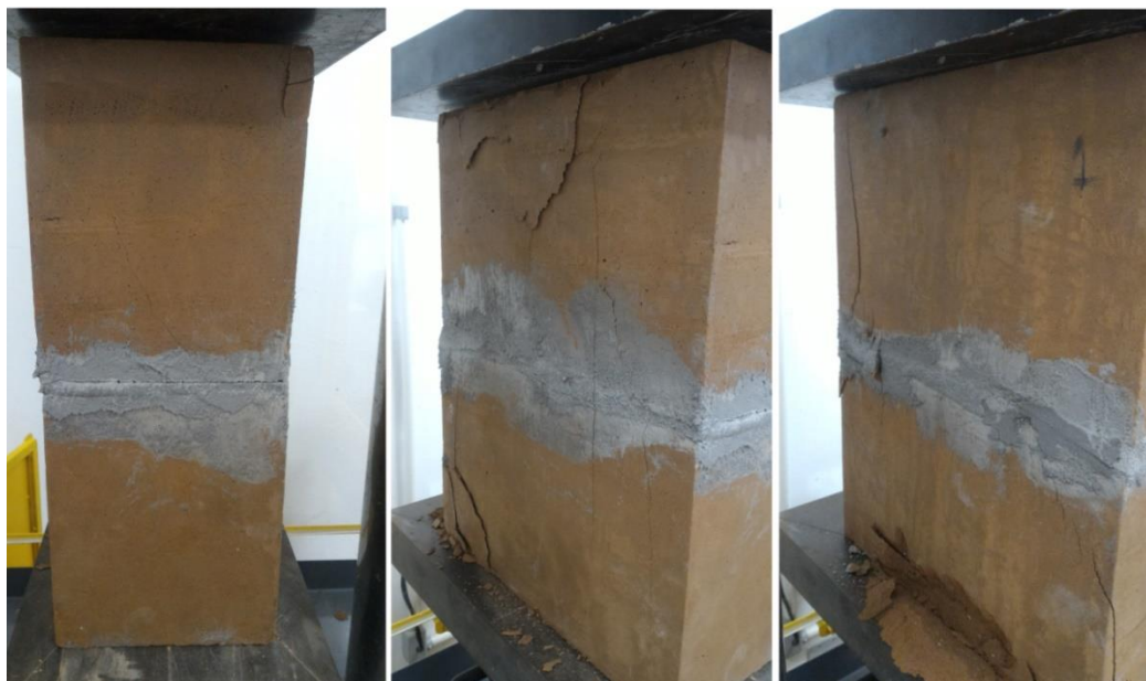
Figura 57- Fissuras horizontais características dos prismas – traço 1
