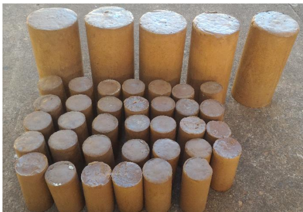
Figura 27- Corpos de prova cilíndricos 5x10 e 10x20
