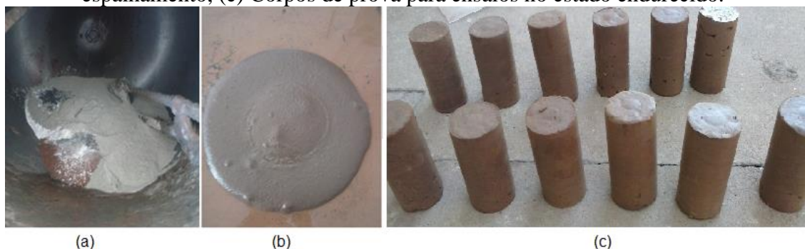
Figura 19- (a) Material em betoneira antes de iniciar a mistura, (b) Resultado do ensaio de espalhamento, (c) Corpos de prova para ensaios no estado endurecido.
