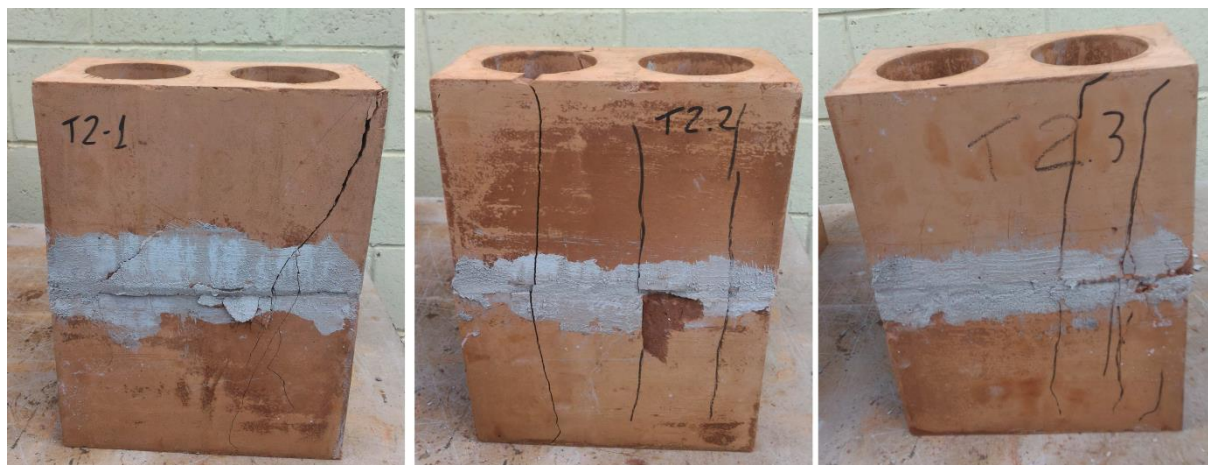
Figura 58- Fissuras características dos prismas – traço 2
