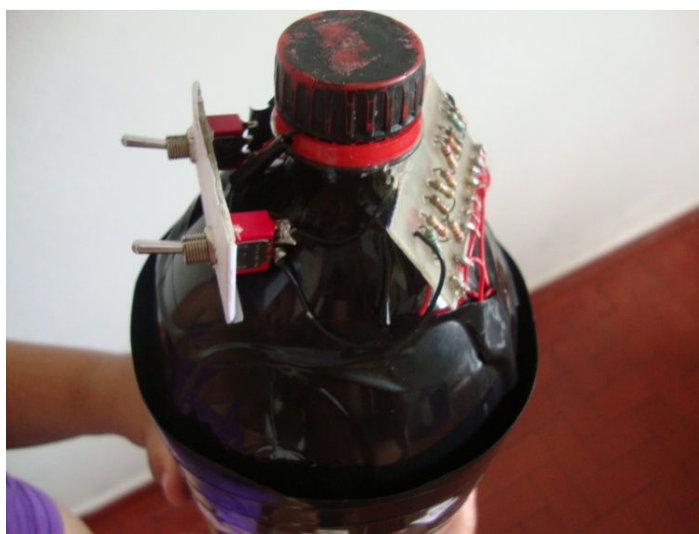
FIGURA 13: Arranjo final das placas dos resistores e interruptores
