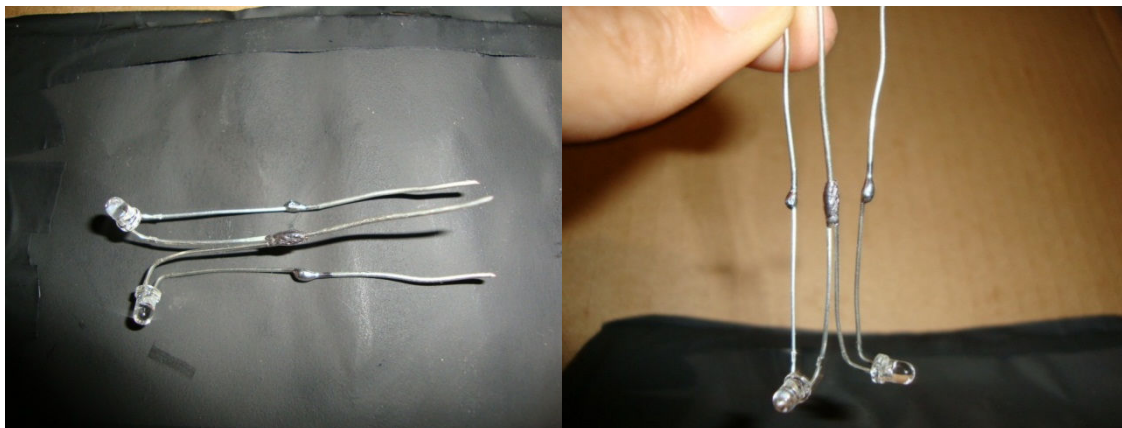
FIGURA 7: Pares de LED's soldados com a polaridade positiva em comum
