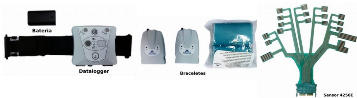
Figura 19 - Componentes do sistema Grip Versatek.
