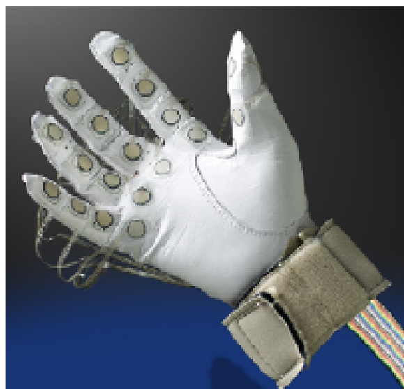
Figura 11 - Luva utilizada para avaliar a contribuição de força de cada segmento da mão.
