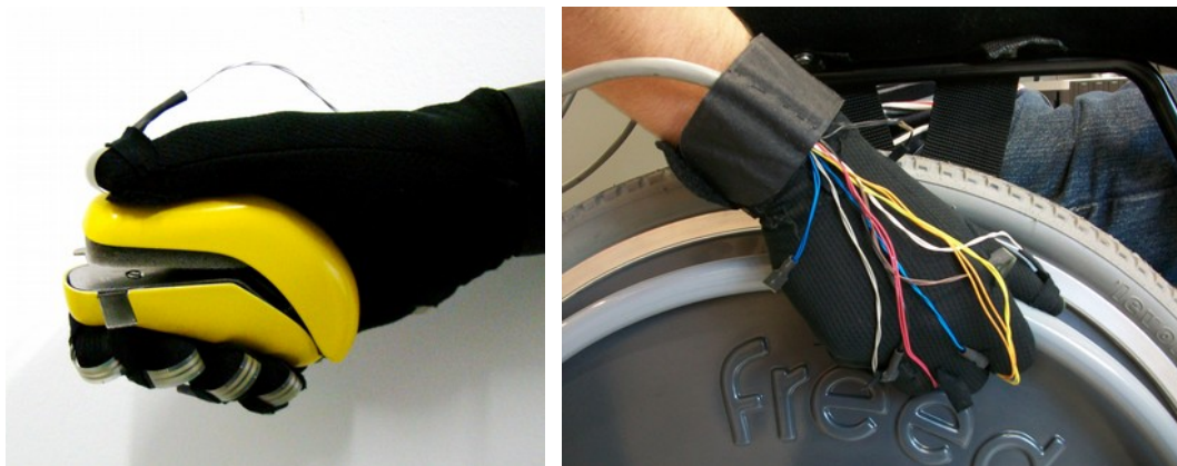
Figura 13 - Luva instrumentada utilizada em estudo sobre cortador de mudas de plantas e aros de propulsão de cadeiras de rodas.
