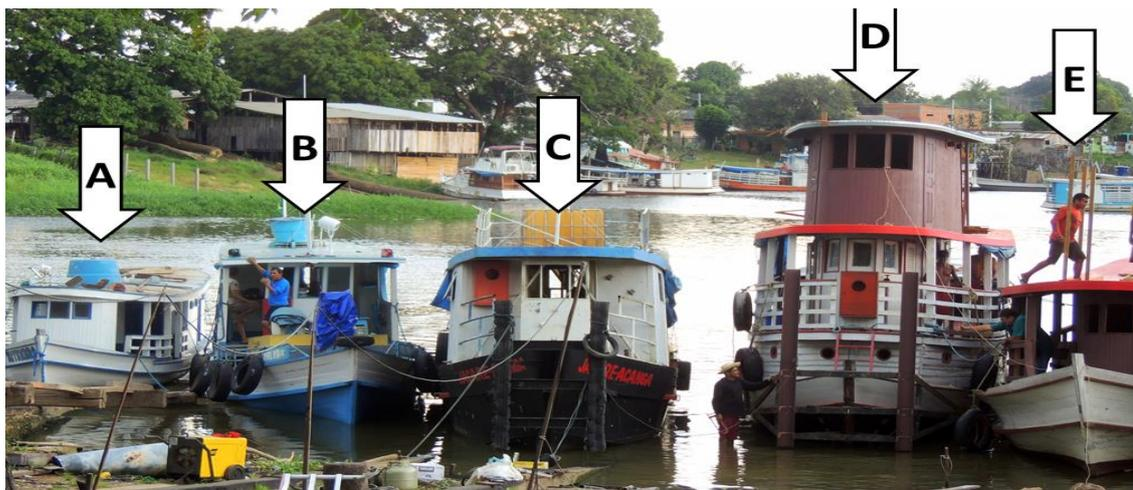
Figura 26: (A) Batelão pequeno de pesca; (B) batelão posto de gasolina; (C) empurrador de ferro; (D e E) batelões sendo adaptados para empurradores (Lagoa da Francesa, Parintins).
