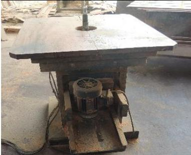
**6 – Tupia:** usada para acabamentos de arredondamento nas extremidades das peças.
