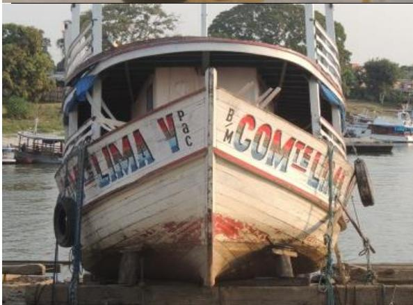
**Balieiro:** Barco com casco alargado e mais lento. Possui maior capacidade de carga nos porões e maior estabilidade em águas turbulentas. Pouco fabricado, pois sua funcionalidade foi substituída pelas balsas.
