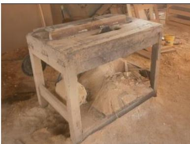
**1 - Bancada de serra circular:** primeira máquina para moldagem das peças, determinando a bitola para posterior aperfeiçoamento na plaina e desengrosso.
