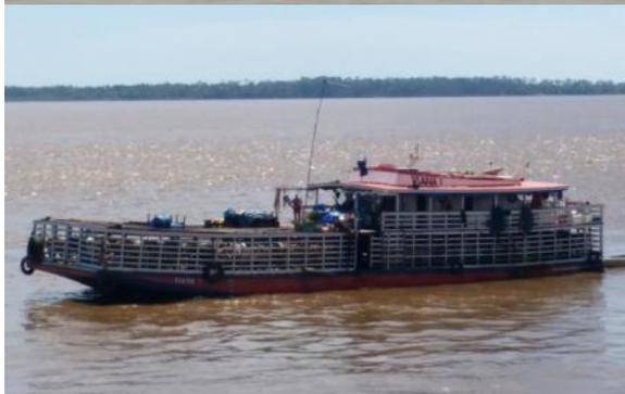
**Balsa média de ferro sem empurrador:** comando da embarcação adaptado em cima da balsa com visibilidade para navegação menor. Produzido em estaleiros de Manaus.
