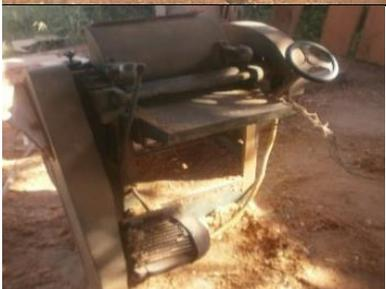
**3 - Desengrosso:** uma das máquinas que não tem a possibilidade de ser construída artesanalmente, pois necessita de maior precisão no desempenho de sua função e acabamento. As encontradas são muito antigas e com improviso de muitas peças.
