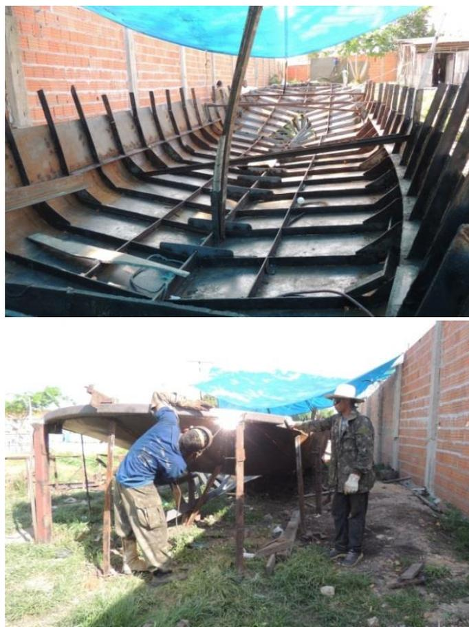
Figura 23: Produção de embarcação de ferro.
