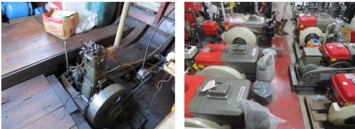
Figura 25: Motor de 9 HP a esquerda prestes a ser substituído por motor 22 HP vendido em lojas locais. Fotos: Estevan Bartoli (05/12/2014).
