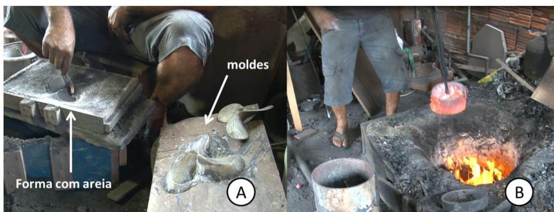
Figura 27: Moldagem e fundição para confecção de hélices.
