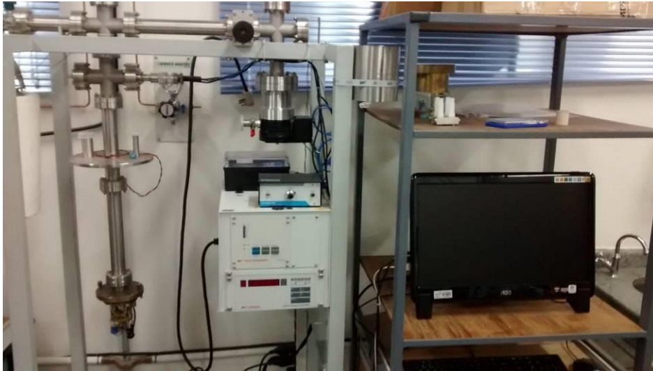
Figura 20: Sistema Sonelastic® utilizado para o cálculo do módulo de elasticidade.
