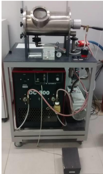
Figura 13: Forno utilizado para fusão das ligas.
