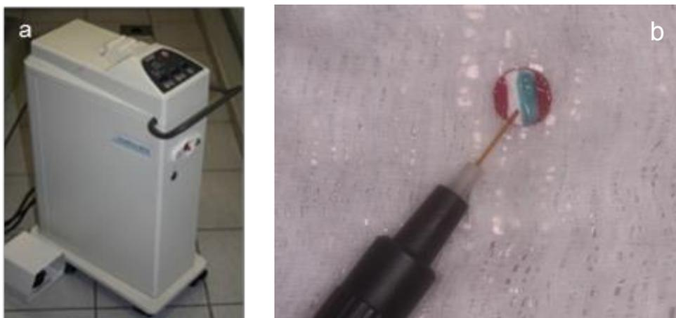
Legenda: a) vista lateral laser Nd: YAG; b) ponta do laser no ato da aplicação.
