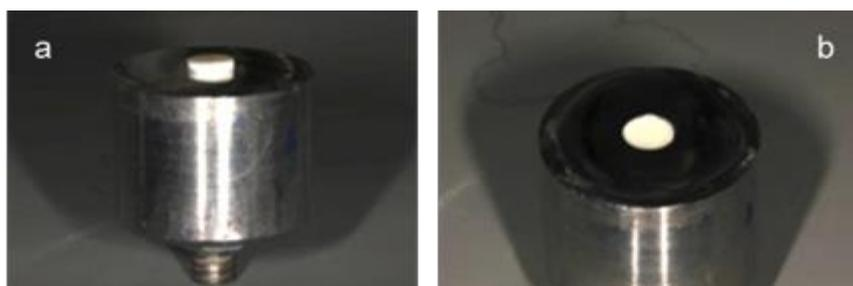
Legenda: a) amostra posicionada na matriz metálica para polimento; b) amostra polida.
