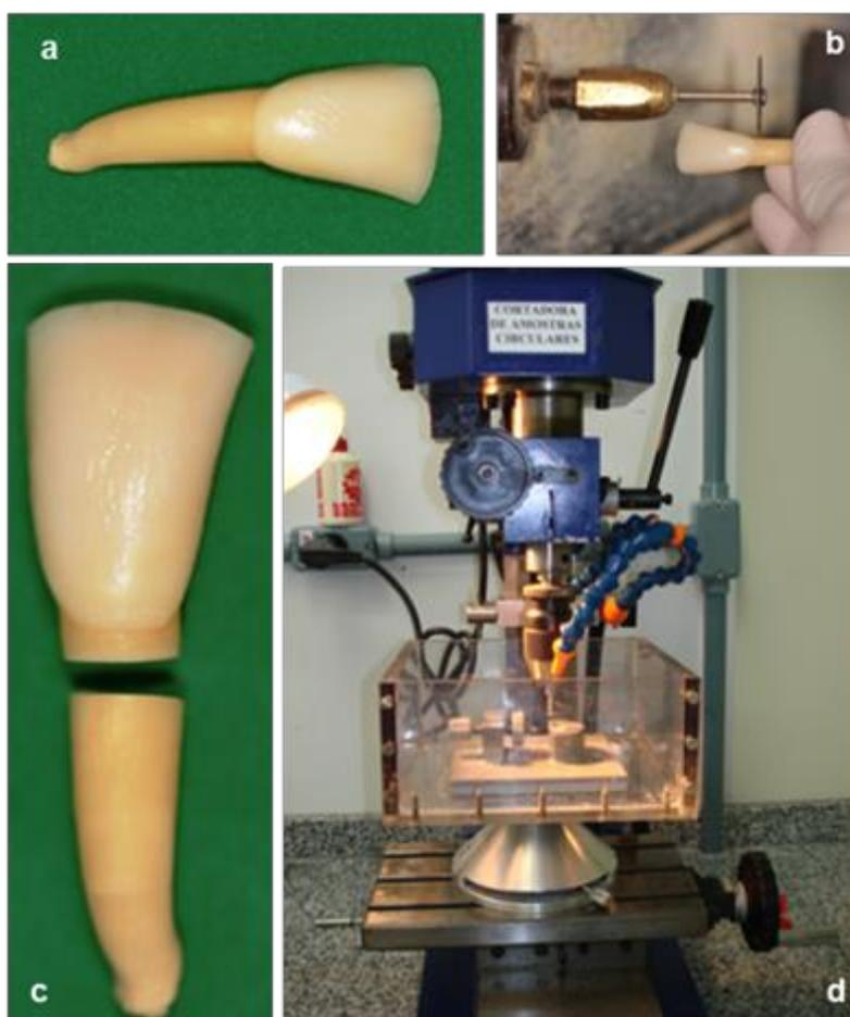
Legenda: a) dente bovino; b) separação coroa-raiz; c) amostra cortada; d) equipamento para corte de amostras circulares.
