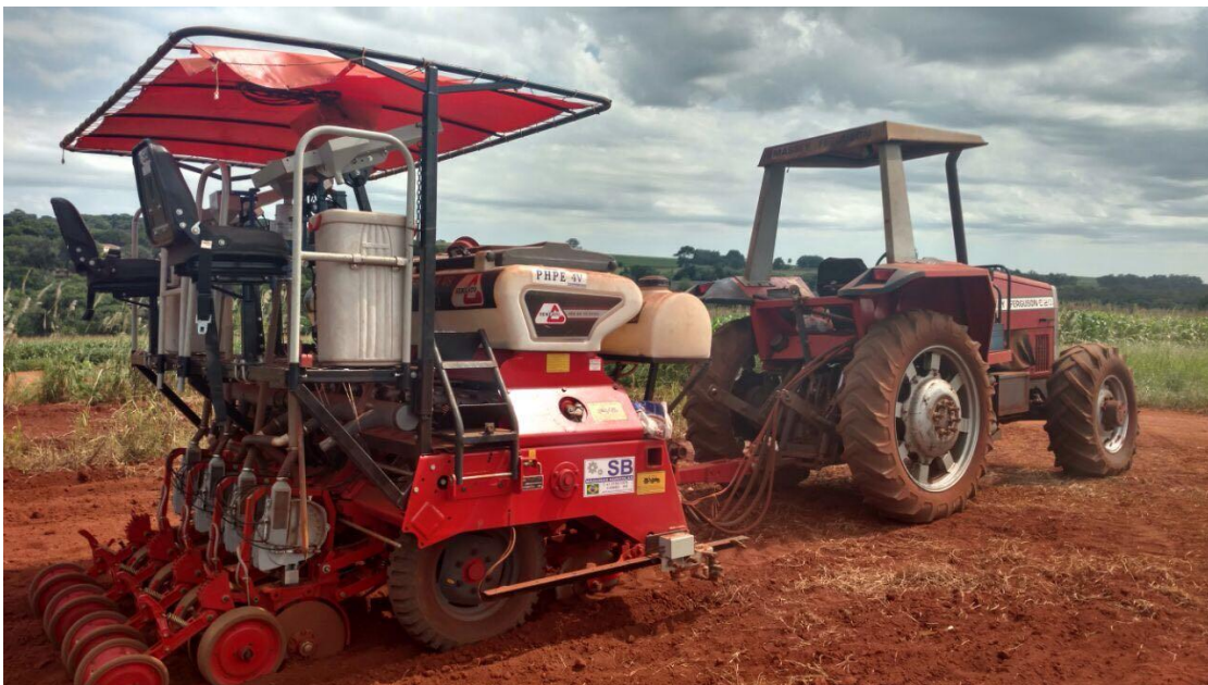
Figura 2. Semeadora de Parcela acoplada no Trator Massey Ferguson, Jaboticabal – SP, Brasil (2016) (1)
