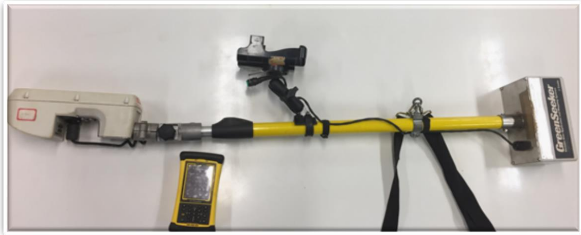
Figura 4. Sensor ativo terrestre GreenSeeker, Jaboticabal – SP, Brasil (2016). Fonte: Próprio autor.
