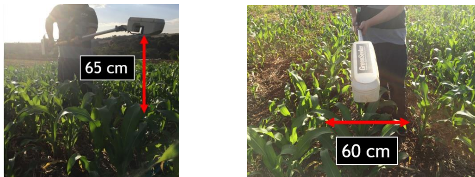
Figura 3. Método de avaliação do NDVI (altura de avaliação do dossel da planta e largura de leitura), Jaboticabal – SP, Brasil (2016).
