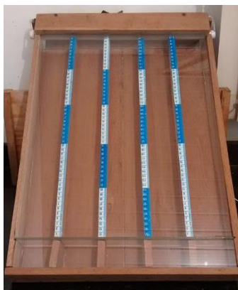
Figura 3: Caixa de observação de madeira para realização do teste de locomoção. Fonte: material elaborado pelo autor.
