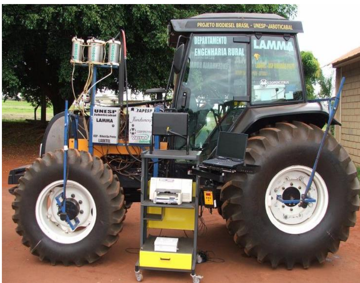
Figura 1. Instrumentação do trator Valtra BM125 i utilizado no ensaio (Lopes, 2006).
