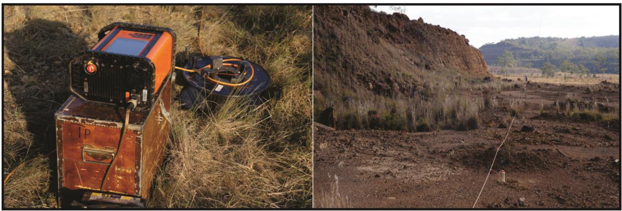
Figura 35 - Imagens do trabalho de aquisição em campo, com o resistivímetro Terrameter LS da ABEM disposto no centro geométrico da linha com os cabos esticados conectados aos eletrodos não polarizáveis.
