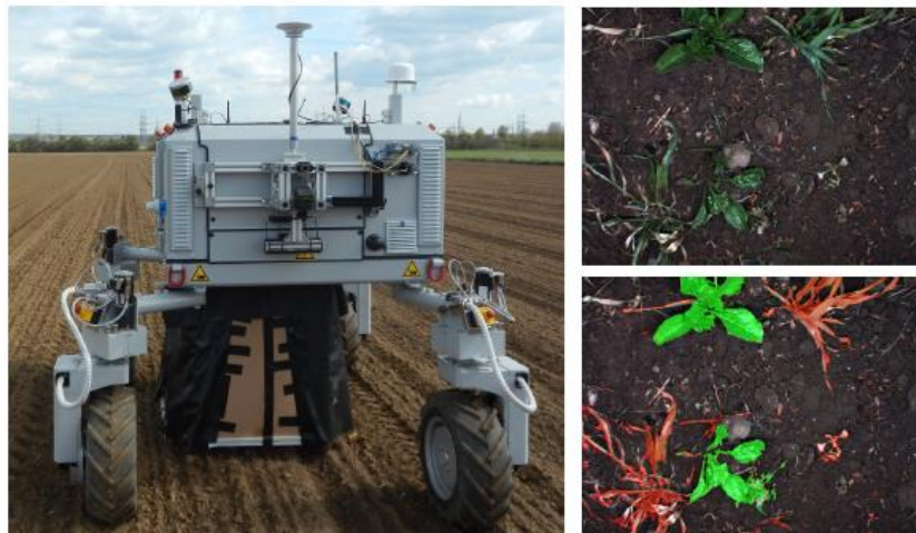
Figura 12 - Plataforma de Coleta de Imagens Bonirob e Plantas Analisadas
