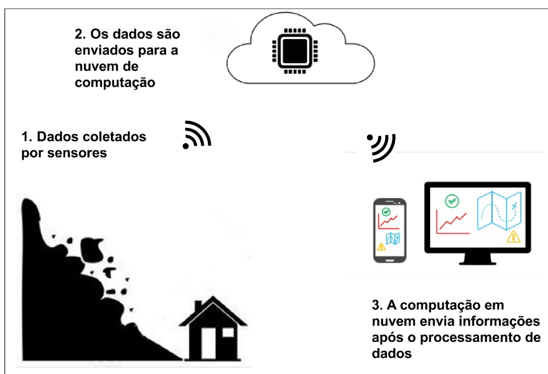
Figura 11 - Arquitetura do sistema de monitoramento
