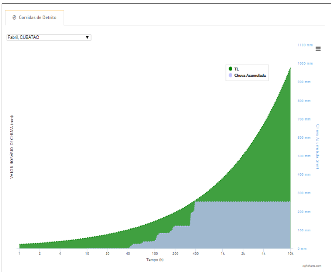
Figura 33 - Evento pluviométrico em andamento e registrado em tempo real na madrugada do dia 04/02/2019 as 05:00 horas (monitoramento de corrida de detritos)
