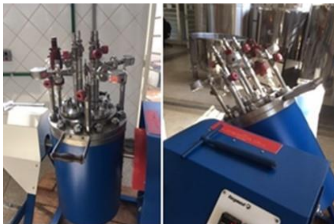
Figura 15 - Reator munido de controle de temperatura, pressão e agitação mecânica (Marca Regmed). FONTE: Autor, (2019).
