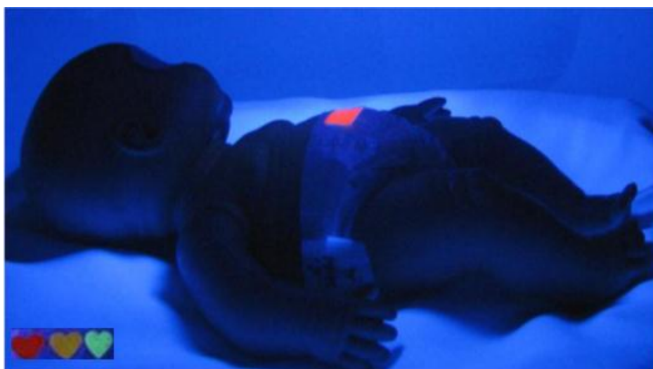
Figura 5: Imagem do sensor de colocado sobre um boneco exposto à luz azul, ilustrando a aplicação do sensor de radiação desenvolvido neste trabalho. Imagem extraída de Ferreira et al (2013) 98 .
