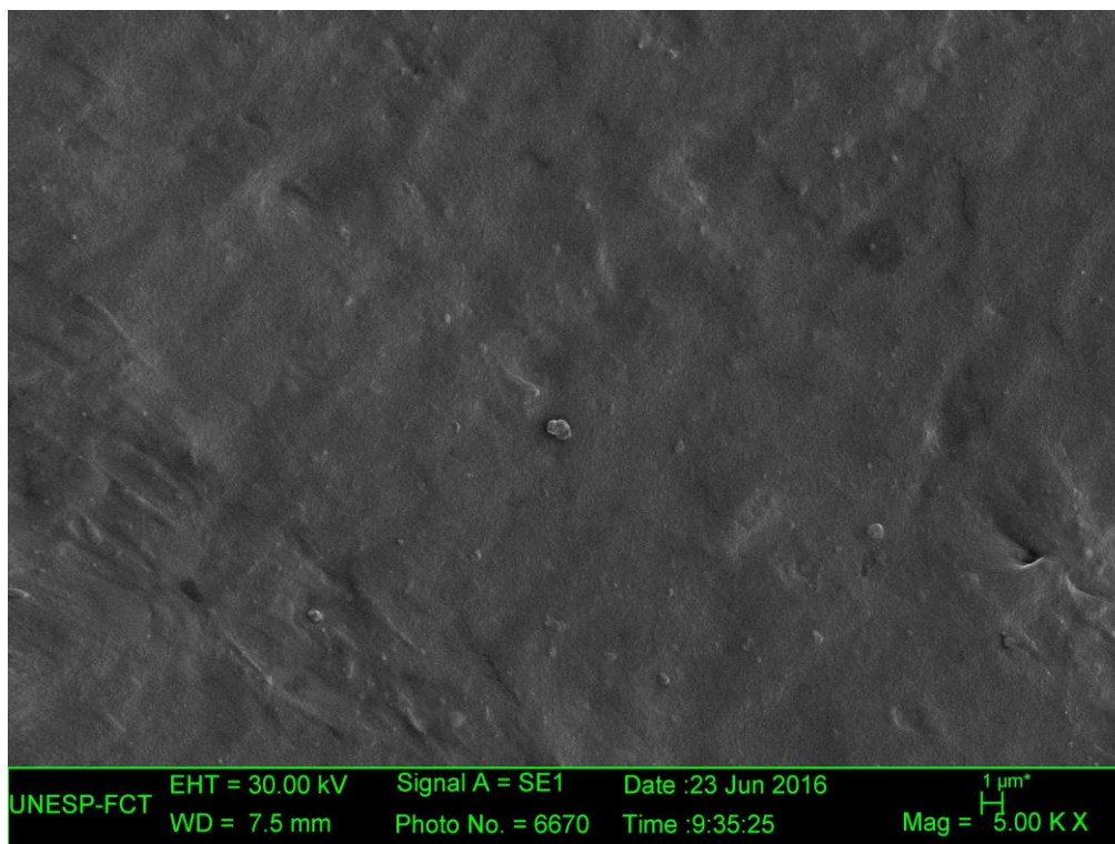
Figura 41: Imagem da membrana luminescente de MEH-PPV/BN. Aumento de 15000 vezes.
