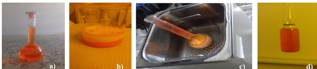
Figura 1: (a) Solução MEH-PPV (b) As nanopartículas foram preparadas usando o método similar ao descrito por Gerhardt et al (2009), (c) banho ultrassônico por 2 h e (d) solução contendo partículas de MEH-PPV hidrofílicas não filtrada.
