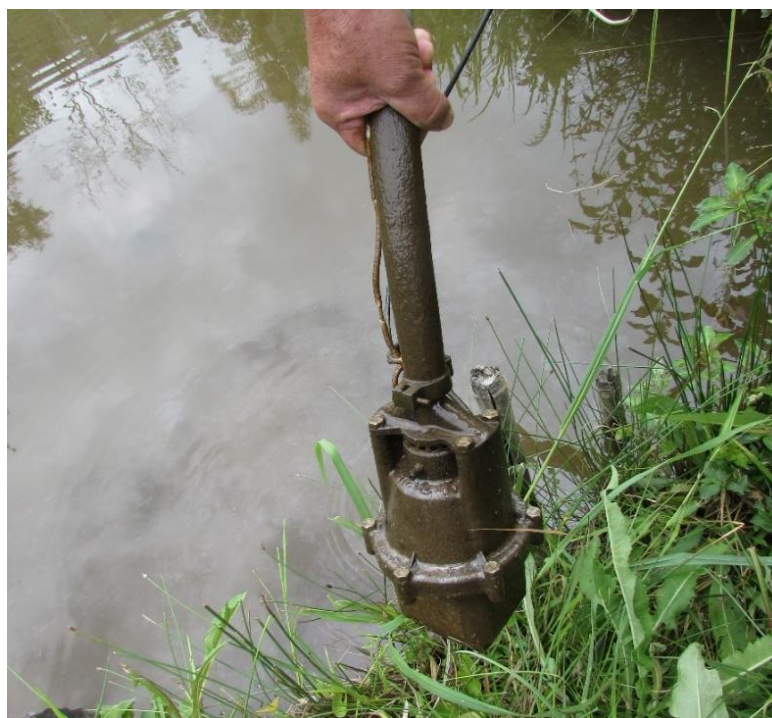
Figura 51 - Bomba d'água elétrica utilizada para irrigação da lavoura
