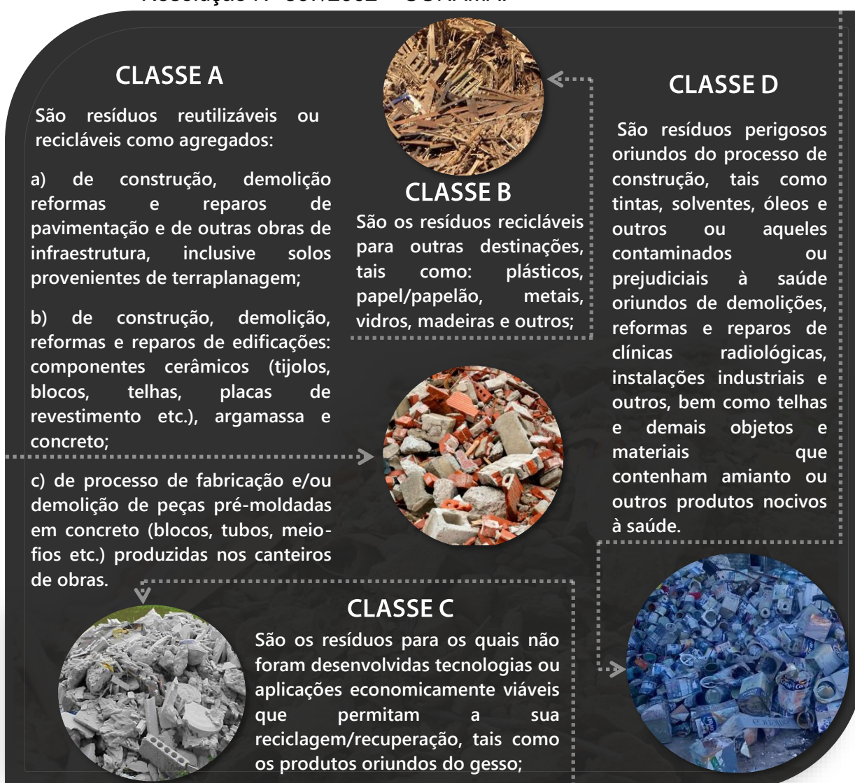
Figura 1. Classificação dos Resíduos de Construção Civil de acordo com a Resolução N° 307/2002 – CONAMA.
