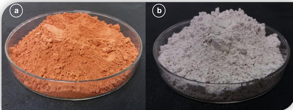
Figura 23. Materiais utilizados para a formulação do clínquer experimental: a) RCV beneficiado; b) Calcário.
