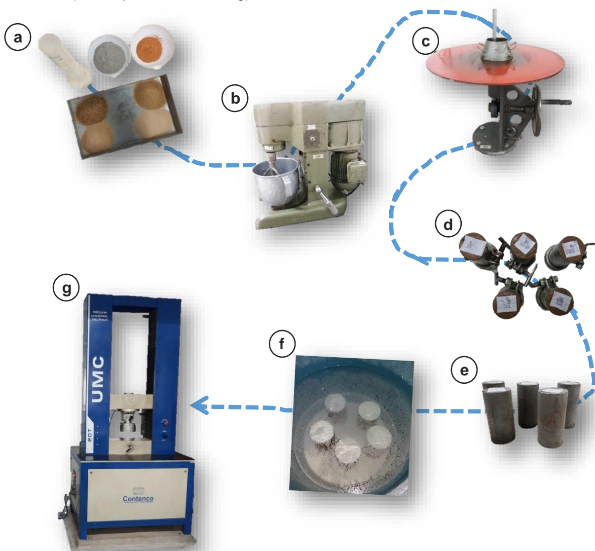
Figura 19. Verificação do índice de desempenho com cimento Portland: a) Separação dos materiais; b) Misturador mecânico; c) Mesa de consistência; d) Moldagem dos corpos de prova; e) Desmoldagem dos corpos de prova; f) Cura por submersão; g) Prensa mecânica.
