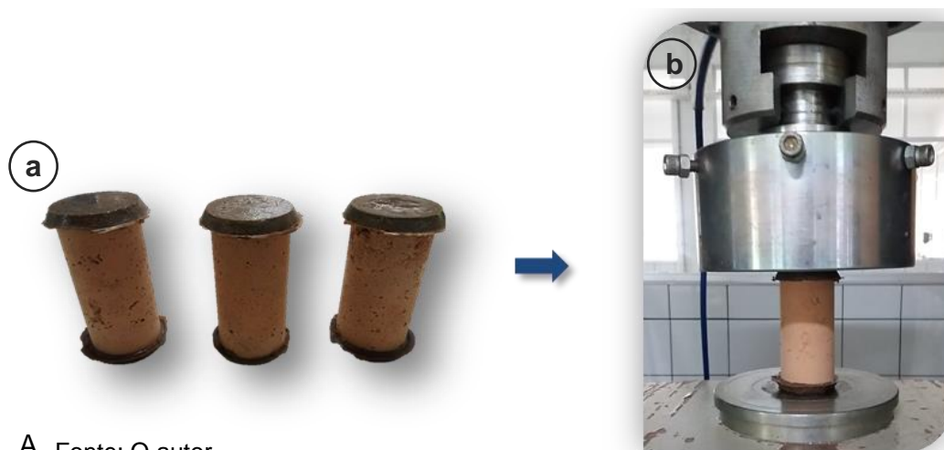
Figura 21. a) Corpos de prova nivelados com mistura e enxofre a quente; b) Corpo de prova centralizado na prensa para ensaio de resistência à compressão.
