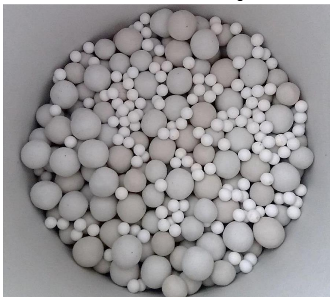
Figura 14. Esferas de alumina acomodadas no interior do vaso de moagem.
