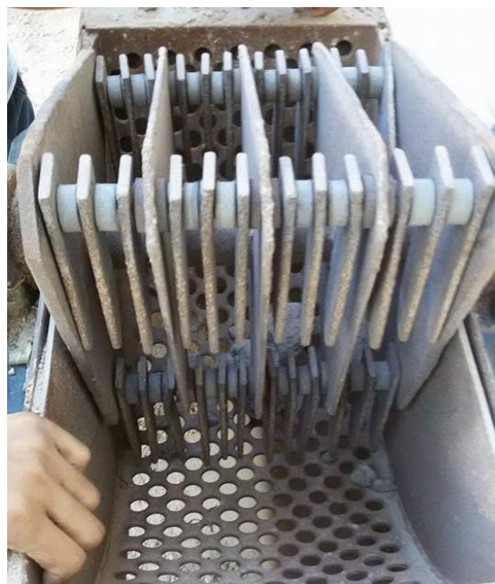
Figura 13. Parte interna do moinho de facas.
