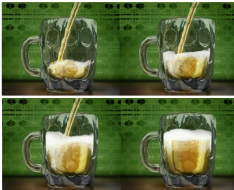
Figura 3.5: Simulação realista do derramamento de cerveja no copo utilizando o método SPH. Fonte: [21].
