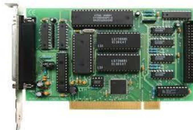
Figura 3.7 - Foto da placa de aquisição de dados MF614 da HUMUSOFT®
