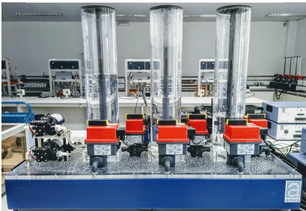
Figura 3.2 - Foto do Sistema de 3 (três) Tanques AMIRA®
