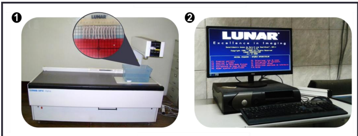
Figura 12. ① Densitômetro DPX-ALPHA para análise de densitometria óssea ② Software de análise para pequenos animais.
