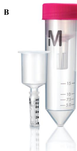
Figura 1A, B. (A) Coluna HisTrap™ de 5 ml utilizada na purificação do ryPoly p 5. (B). Amicon (Ultra-15 Centrifugal Filter Units) de 10 kDa.
