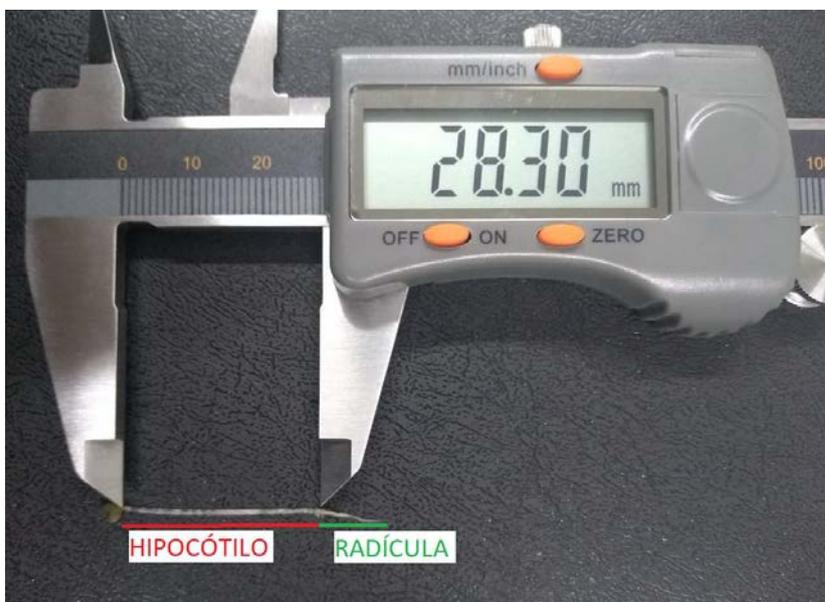
**Figura 2.** Paquímetro utilizado para medição das raízes de *L. sativa*, diferenciando hipocótilo e radícula.
