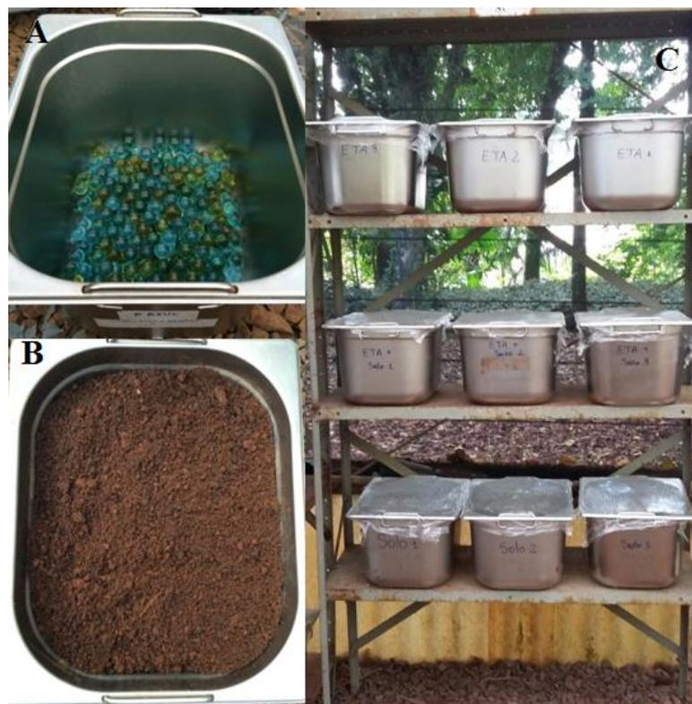
**Figura 1.** A. Cuba de inox contendo esferas de vidro, as quais atuam como primeira camada antes da adição das amostras; B. Cuba de inox contendo amostra; C. Disposição das amostras para realização do processo de biorremediação em escala piloto, no jardim experimental da Universidade Estadual Paulista “Júlio Mesquita Filho”, campus de Rio Claro.
