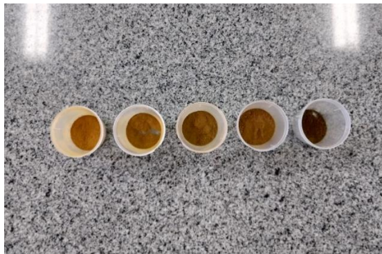
Figura 10 – Misturas de CCTO/OGR nas diferentes proporções de 1, 2, 5, 10 e 20% (da esquerda para direita).
