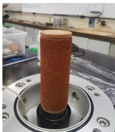
Figura 3.9 – Montagem corpo de prova na câmara triaxial
