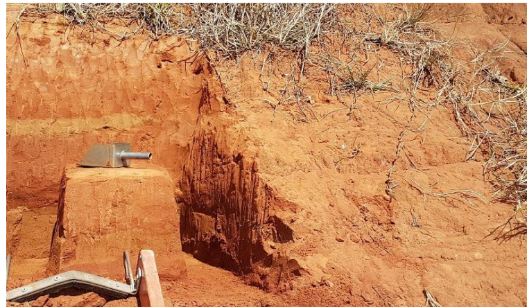
Figura 3.2 – Amostra indeformada sendo retirada do talude estudado.
