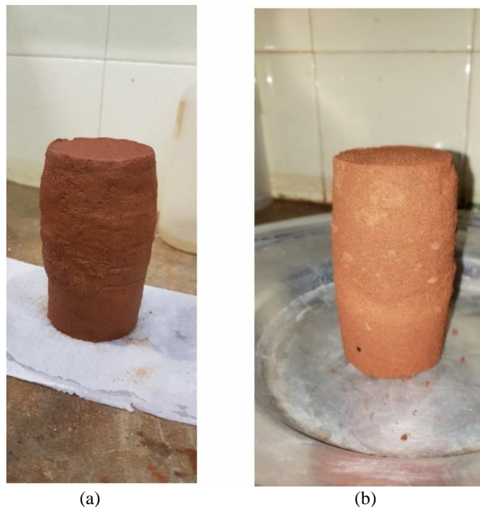
Figura 4.9 - Corpos de prova após ensaio de compressão triaxial: (a) saturado; (b) não saturado
