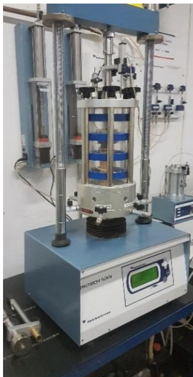
Figura 3.10 – Ensaio de compressão triaxial montado.
