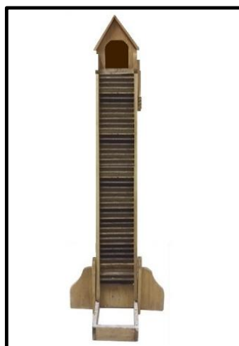
Fig. 4 – Modelo de escada utilizado durante a execução de treinamento de força e treinamento concorrente.
