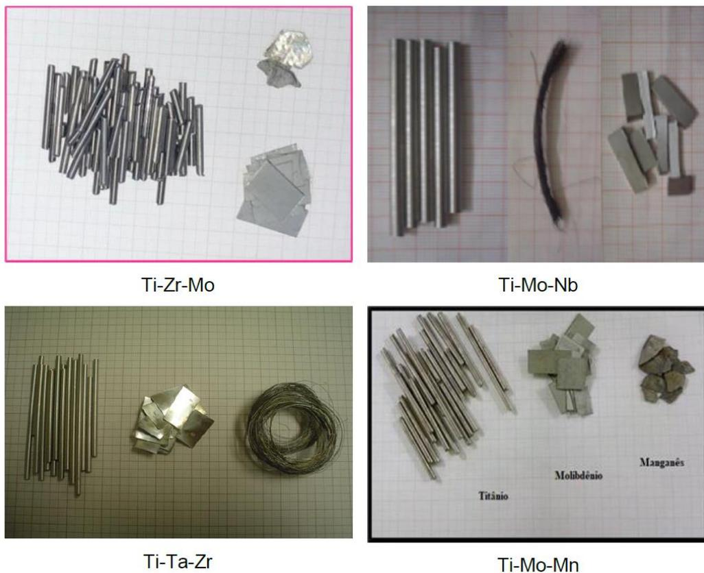
Figura 1: Materiais precursores utilizados para a fusão das ligas que serão analisadas neste trabalho.
