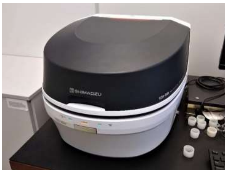
Figura 9: Equipamento Shimadzu EDX-7000 utilizado no ensaio
