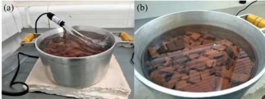
Figura 15: (a) Corpos de prova no processo de fervura em água destilada; (b) Corpos de prova no processo de submersão por 22horas
