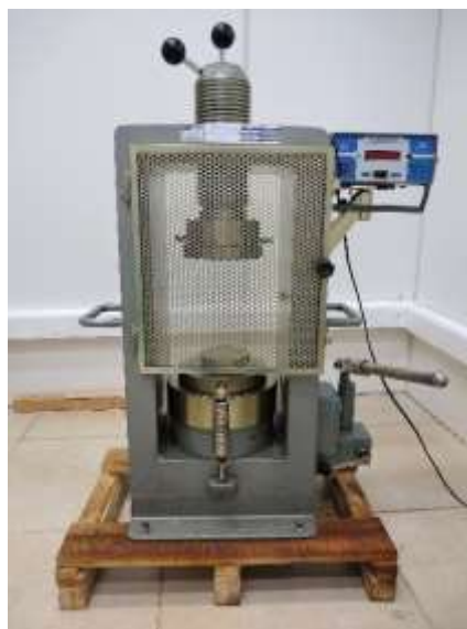
Figura 11: Prensa Contenco utilizada na confecção dos corpos de prova
