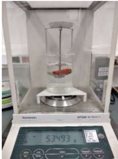
Figura 16: Pesagem do corpo de prova pelo método de Arquimedes
