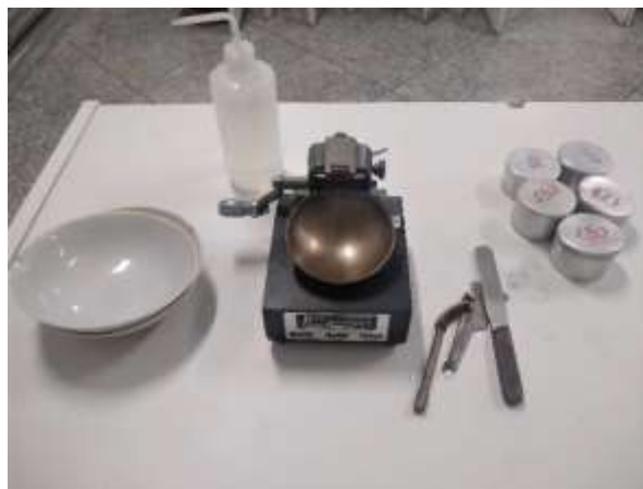
Figura 6: Equipamentos utilizados para o ensaio de limite de liquidez
