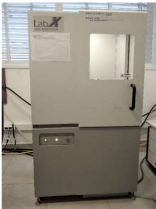
Figura 8: Equipamento Shimadzu XRD-6000 utilizado no ensaio
