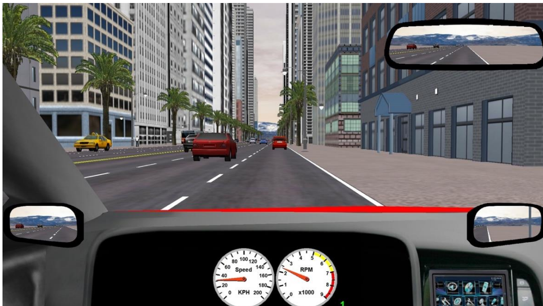
Figura 7 - Visão do participante mostrando o ambiente interno do carro com velocímetro, contador de giros, conjunto de espelhos e o ambiente virtual urbano 3D.
