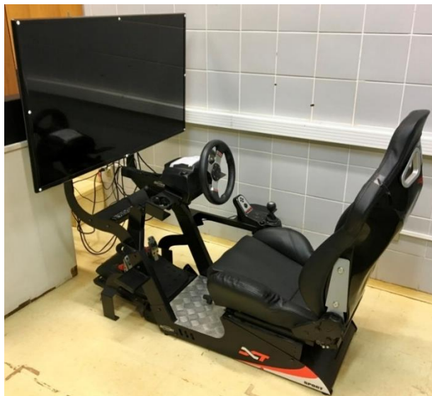
Figura 2 - Estrutura montada do Cockpit com banco reclinável e ajustável, suporte para a televisão Samsung 46" e kit de acessórios Gamer Logitech G27 com pedais, câmbio e volante acoplado ao Cockpit.
