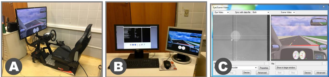
Figura 28 - A: Imagem da televisão Samsung de 46" exibindo a imagem do simulador. B: Tela de controle do pesquisador mais a tela de replicação da imagem que o participante vê na televisão. C: Imagem do olho do participante mais a replicação da tela que o participante está observando.
