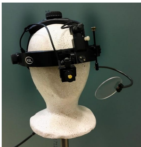
Figura 1 - Capacete Eye Tracker ASL H6 da Applied Sciences Laboratories. Equipamento que coleta dados do movimento dos olhos, da cabeça e diâmetro da pupila.
