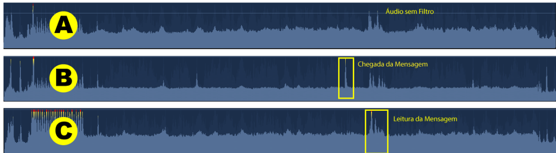
Figura 29 - Apêndice: Comparativo entre os canais de áudio. A: Canal de áudio de uma tentativa sem filtro. B: Canal de áudio de uma tentativa com o filtro para realçar o instante da chegada da mensagem ao relógio inteligente. C: Canal de áudio de uma tentativa com o filtro para realçar o período em que o participante leu a mensagem de texto.
