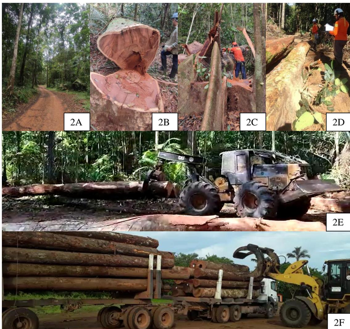
Figura 2A. Estrada de acesso ao pátio da floresta; 2B. Atividade de derrubada das árvores, com uso de motosserra; 2C. Traçamento das toras; 2D. Cubagem e romaneio das toras: medição e identificação das toras manejadas; 2E. Arraste das toras até o pátio na floresta; 2F. Transporte das toras até a unidade primária de beneficiamento.
