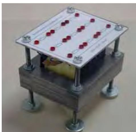
Figura. 5.7 – Protótipo do bloqueador eletromagnético.
