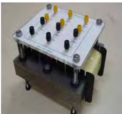
*Figura 5.4 – Foto do protótipo construído (1kVA/ 220V)*
