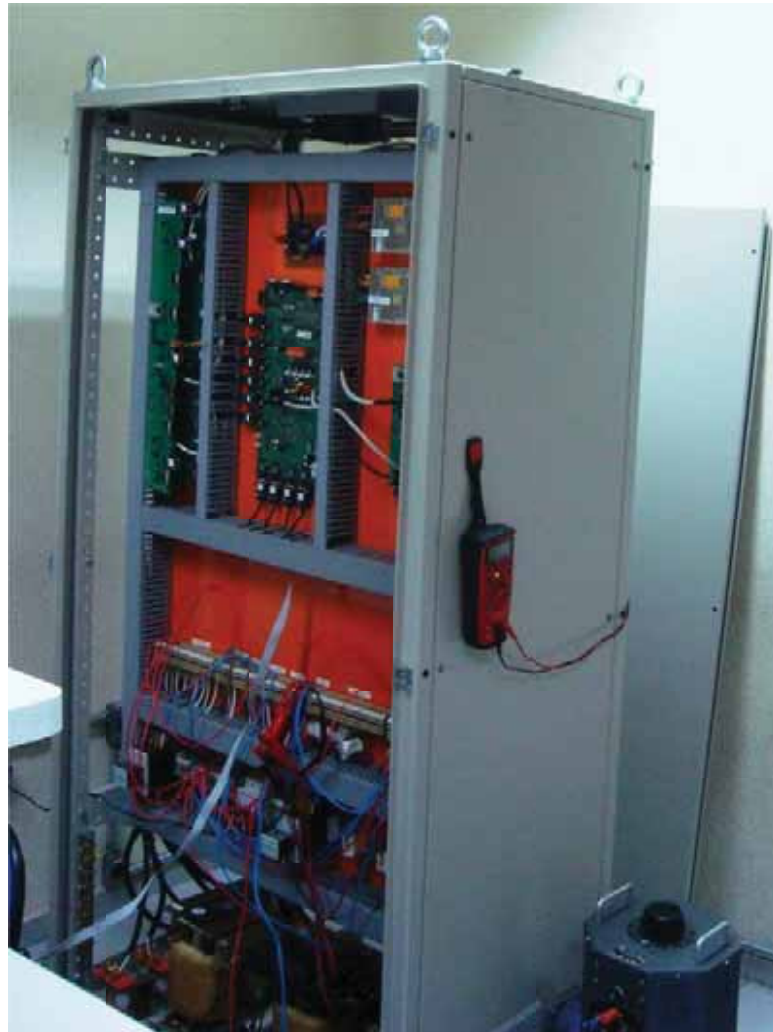
Figura 65: Protótipo do condicionador modular de energia elétrica desenvolvido pelo GASI.
