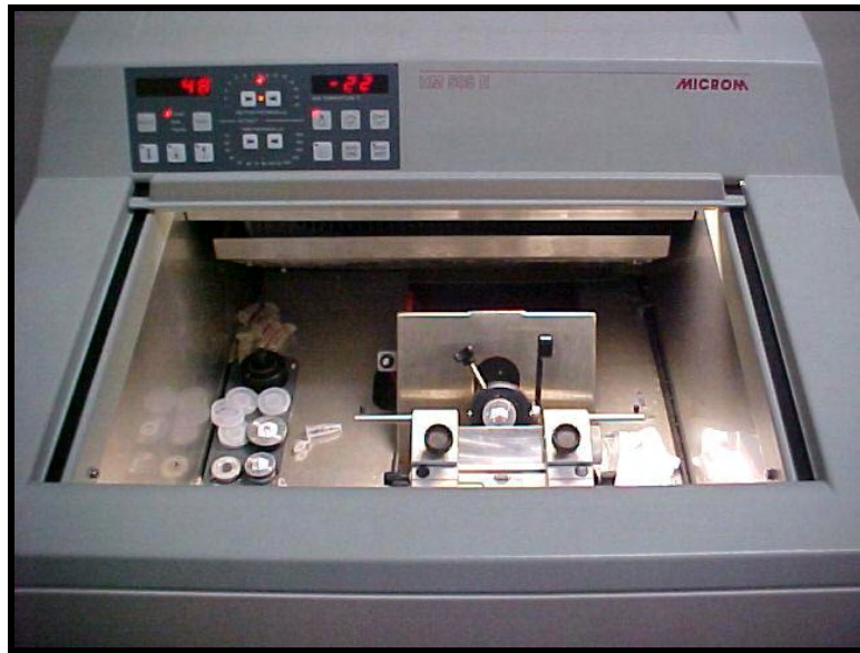
Figura 14: Micrótomo criostato - HM 505 E Microm com blocos de tecido muscular fixados.
