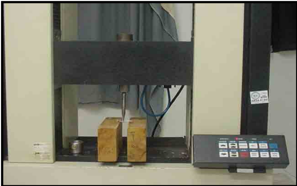
Figura 7 – Aspecto da máquina universal de ensaios mecânicos com o corpo de prova montado para ensaio de flexão em três pontos.
