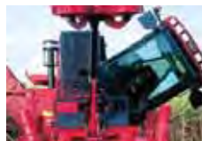
Radiador basculante com portas duplas facilita a limpeza.
