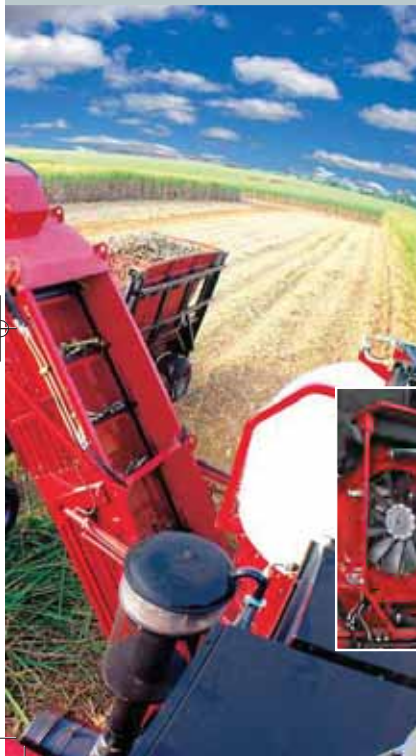
Radiador basculante com portas duplas facilita a limpeza.
