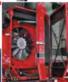
Radiador basculante com portas duplas facilita a limpeza.
