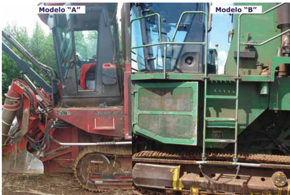
Figura 16 - Degráus de acesso dos equipamentos.
