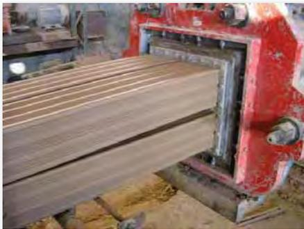
Figura 65 – Detalhe da saída da massa cerâmica da extrusora
