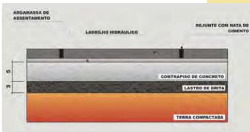
Figura 29: Modelo esquemático para aplicação de petit-pavet
