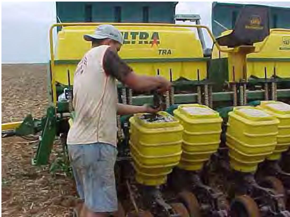
Foto 26: Tipo de máquina utilizada no plantio da soja. Apesar do uso de tecnologias, parte do trabalho é manual e de alto risco, pois os trabalhadores não utilizam qualquer equipamento de proteção (luvas, máscaras) para preparar a semente para o plantio, misturando inseticidas, fungicidas e adubos com as mãos.
