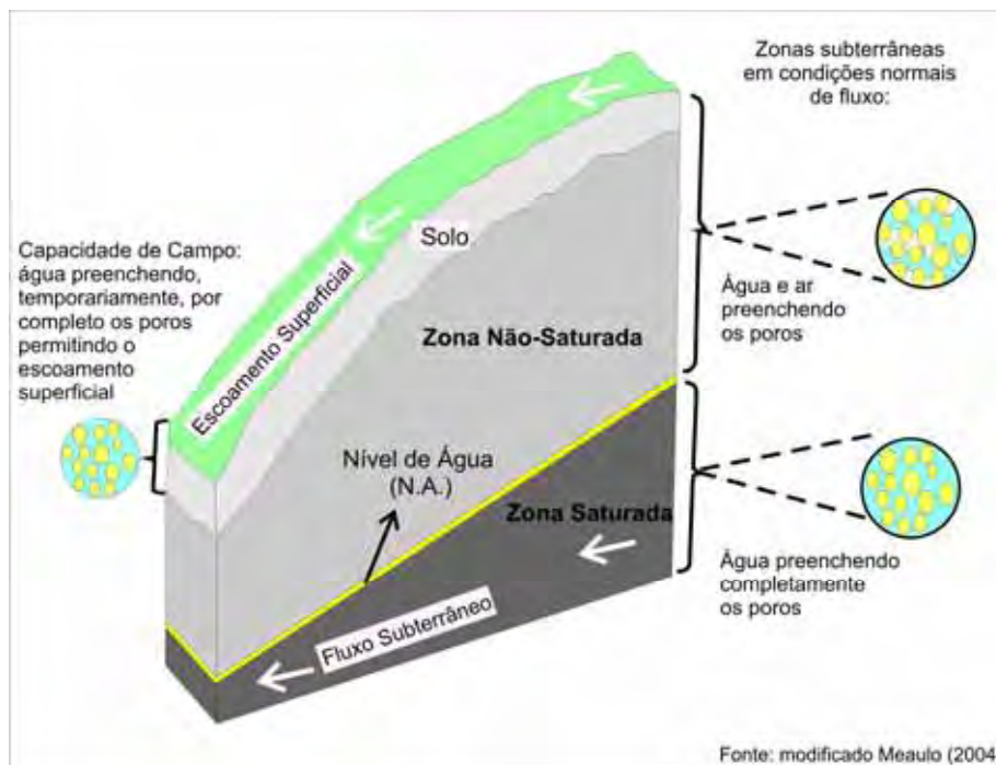
Figura 3: Diagrama generalizado das zonas subterrâneas de água em condições normais de fluxo e em capacidade de campo.
