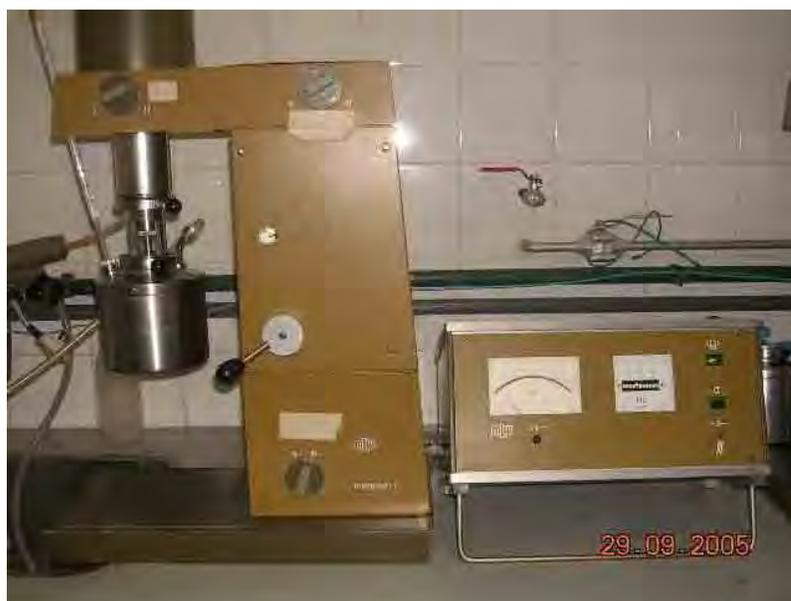
**Figura 3.1** – Reômetro rotacional de cilindros concêntricos.
