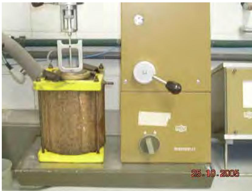
**Figura 3.2** – Reômetro de agitação.
