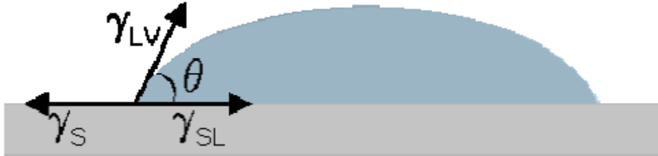
Figura 14: Ângulo de contato ( \theta ) entre a gota de um líquida e uma superfície sólida plana e horizontal.
