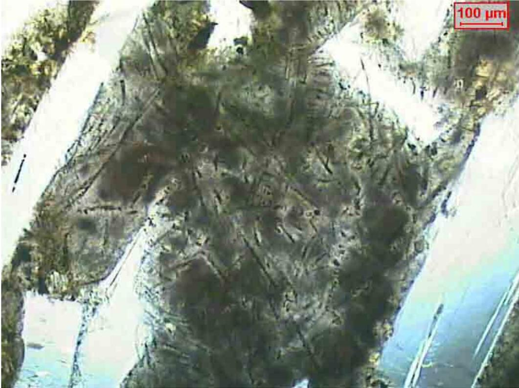
Foto VI.9 – Textura intersertal em amostra coletada próximo a cidade de Iracemápolis. O material vítreo, rico em cristalitos, ocupa os interstícios dos cristais ripiformes de plagioclásio. Nicóis paralelos.
