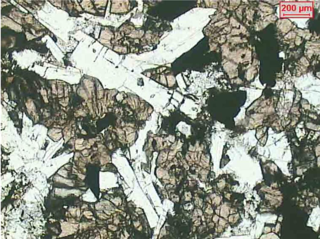
Foto VI.5 – Diabásio com textura intergranular, onde cristais ripiformes de plagioclásio apresentam grãos intersticiais de clinopiroxênio, além de minerais opacos subhedrais. Amostra coletada em sill no distrito de Assistência, próximo a cidade de Rio Claro. Nicóis paralelos.
