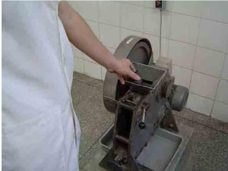
Foto II.1 – Britador primário, onde as amostras são reduzidas a granulometria média de 3 a 4 cm. Equipamento localizado no Laboratório de Preparação de Amostras do Departamento de Petrologia e Metalogenia, IGCE / UNESP, campus Rio Claro (SP).
