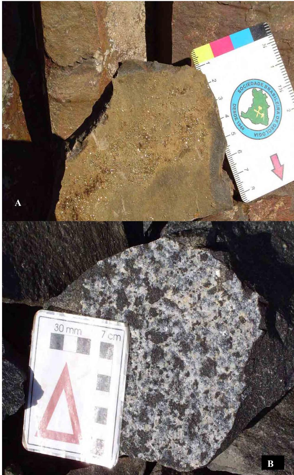
Foto VI.17 – Fraturas preenchidas por pirita (A) e calcita (B), respectivamente em derrame próximo a cidade de Ribeirão Preto e sill próximo a cidade de Limeira (GSI), na Pedreira Cavinato 2.
