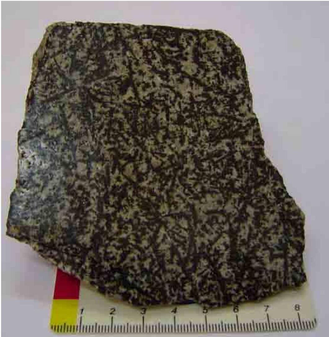
Foto VI.2 – Amostra de diabásio coletada na Pedreira Cavinato, próximo à cidade de Limeira. De maneira isolada na região, este sill representa uma rocha com aspecto leucocrático e grossa.
