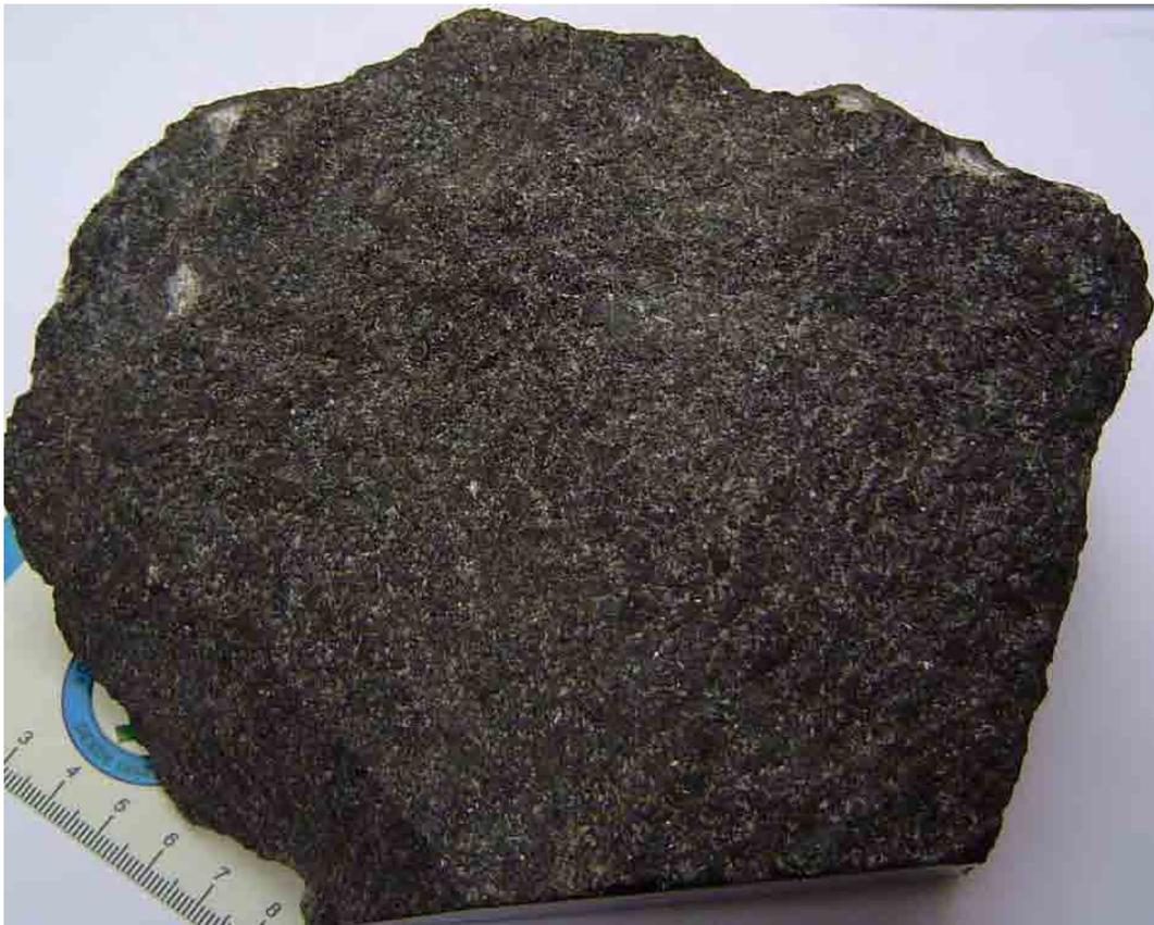
Foto VI.1 – Amostra de diabásio coletada em sill próximo à cidade de Nova Odessa, predominantemente mesocrática e com granulação fina – média.
