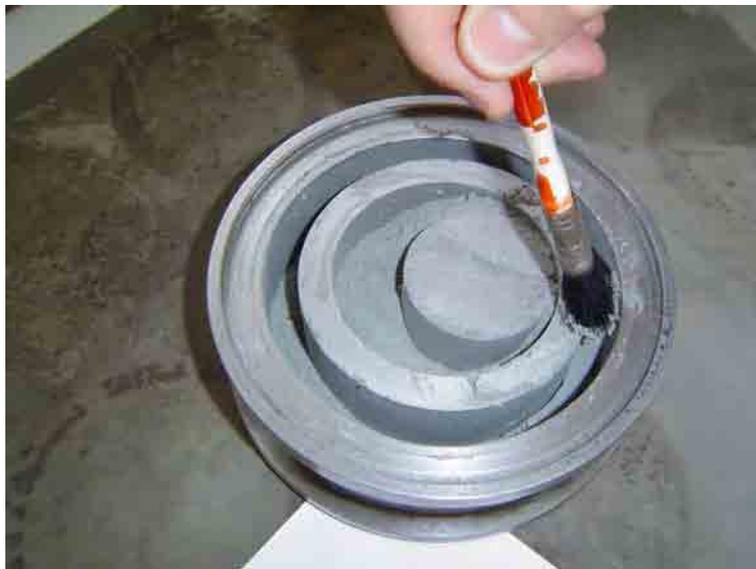
Foto II.2 – Painela de carbeto de tungstênio do moinho, onde a amostra é reduzida a granulometria inferior a 200 mesh. Equipamento localizado no Laboratório de Preparação de Amostras Geológicas e Pedológicas do Departamento de Petrologia e Metalogenia, IGCE / UNESP, campus Rio Claro (SP).
