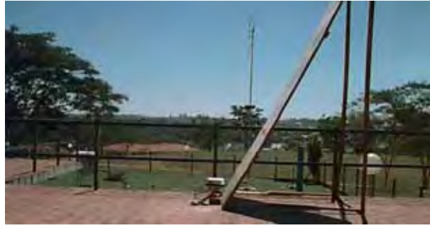
Figura 4.1: Placa de ferro de 1,2 x 3,0 metros a 0,1 m de distância da antena do receptor.
