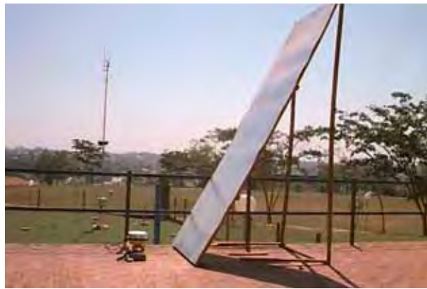
Figura 4.2: Placa de ferro de 1,2 x 3,0 metros a 0,5 m de distância da antena do receptor.
