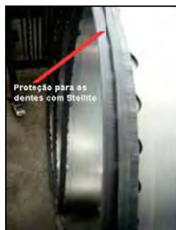
Figura 2.24 - Proteção para os dentes com Stellite.
