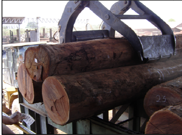
Figura 3.9 – Alimentação de toras em mesa transportadora para o processo de desdobro.
