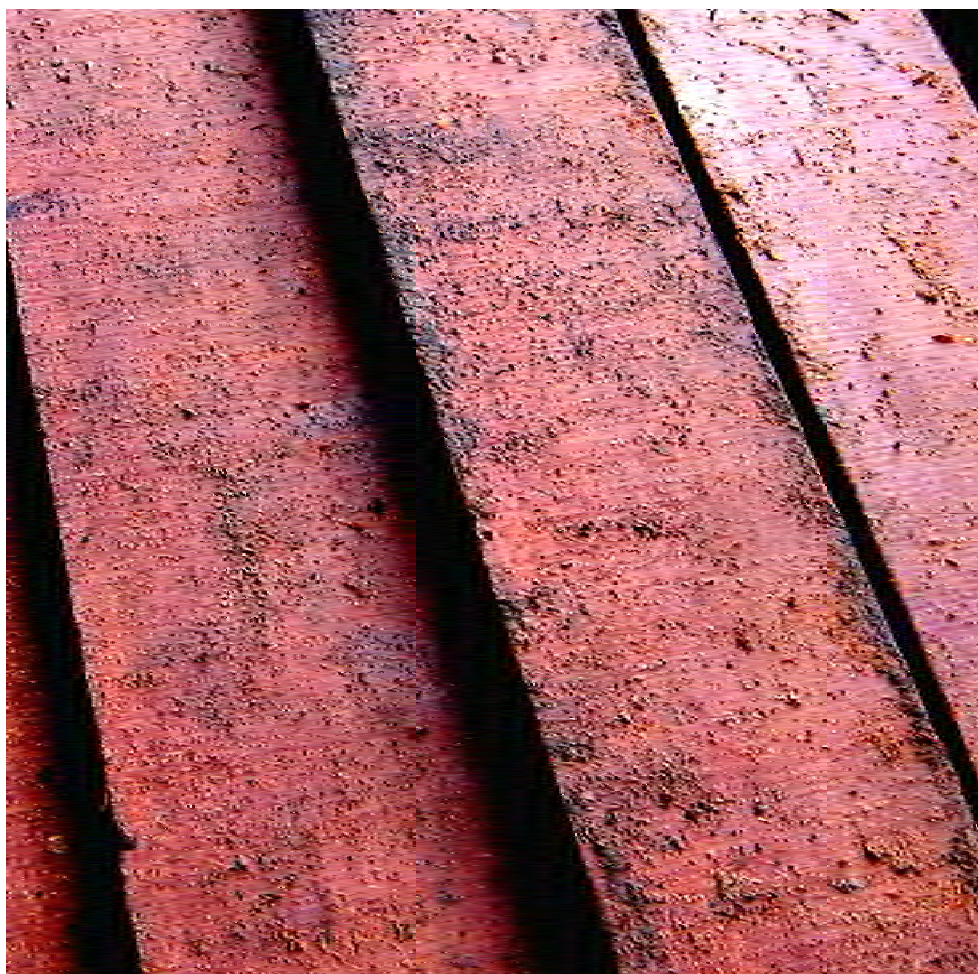
Figura 4.3 - Acabamento superficial da madeira serrada com ferramenta com ponta de stellite
