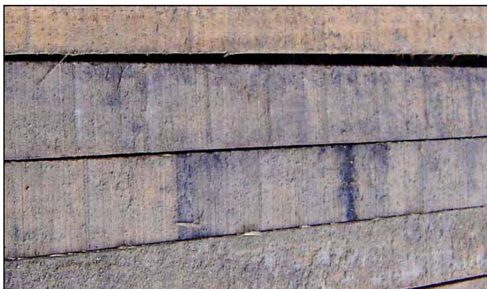
Figura 4.2 - Acabamento superficial da madeira serrada com ferramenta convencional
