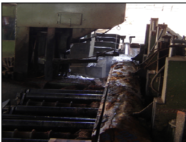
Figura 3.8 – Serra de fita usinando tora de Maçaranduba com carro porta toras.
