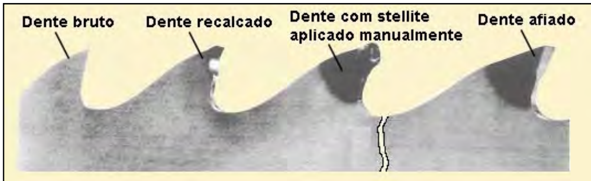
Figura 2.21 - Etapas de aplicação do Stellite manualmente (Adaptado de VOLLMER, [2000?])
