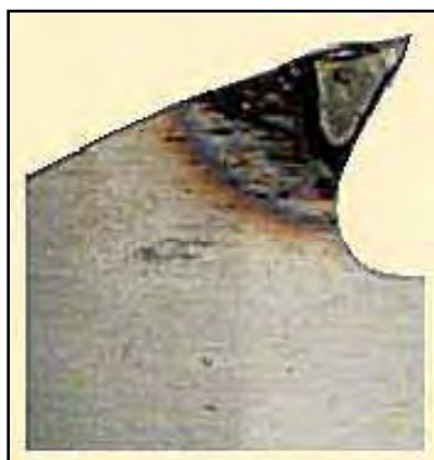
Figura 2.22 - Recobrimento com Stellite usando processo de fusão por plasma ( Adaptado de VOLLMER, [2000?])
