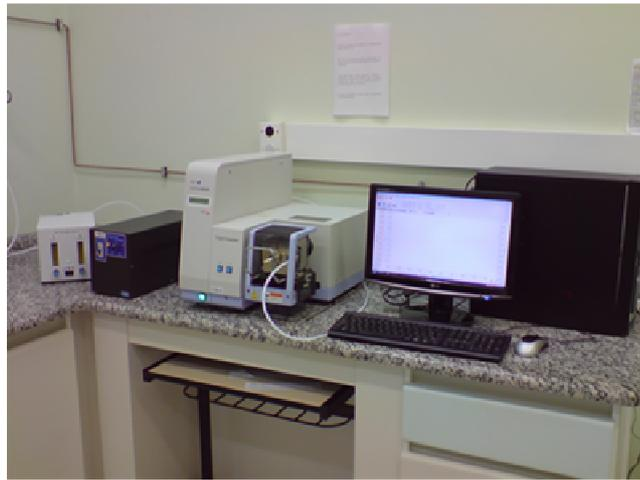
Figura 17. Equipamento de TGA da SEIKO, modelo 6000 utilizado.
