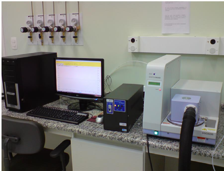
Figura 16. Equipamento de DSC da Seiko, modelo 6220 utilizado.
