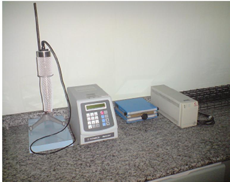
Figura 12. Ponteira Ultrassônica da marca Sonics & Materials.
