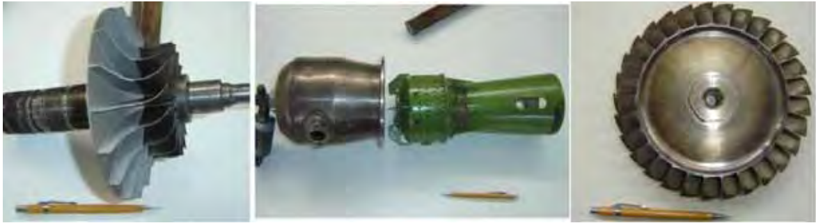
Figura 3.2 – Turboeixo Rover 1/S60, compressor/câmara de combustão/turbina.
