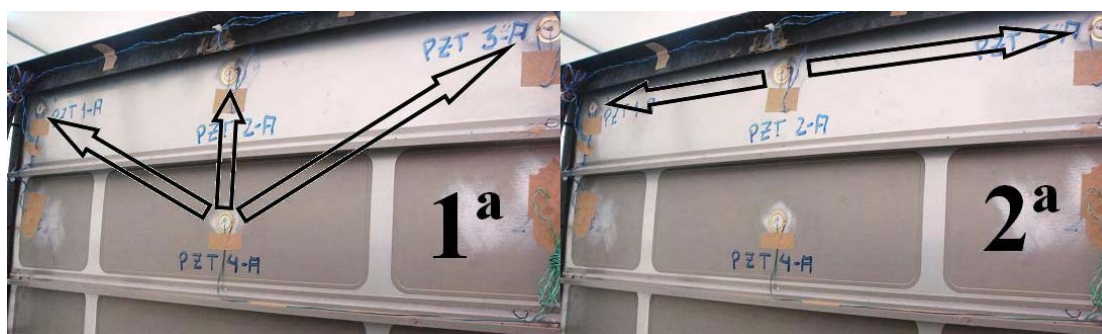
Figura 6.91. Sequência de excitação realizada na região interna do painel aeronáutico.
