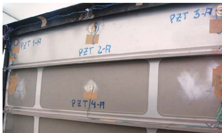
Figura 6.90. Configuração de PZTs formada na superfície interna do painel.
