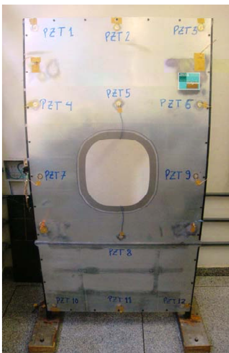
Figura 6.60. Configuração de PZTs formada na superfície externa do painel.
