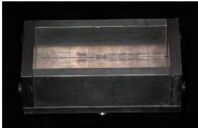
Figura 2 – Matriz de alumínio montada para a confecção do bloco de poliuretano.
