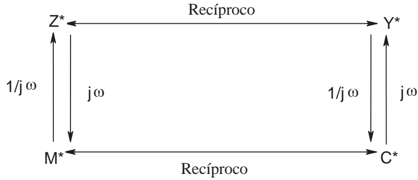
Figura 4.4. Representação esquemática da seqüência matemática dos formalismos correlacionados com a impedância, onde Z^*(\omega) representa a impedância complexa, Y^*(\omega) a admitância, C^*(\omega) a capacitância e M^*(\omega) o módulo elétrico.
