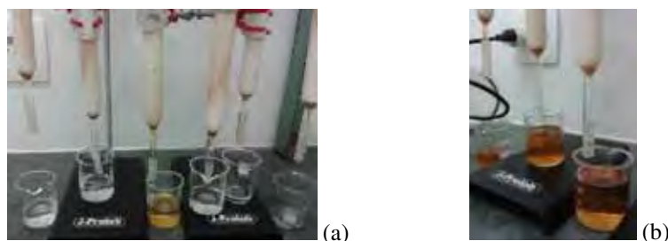
Figura 6: (a) Procedimento de eluição das Substâncias Húmicas Aquáticas; (b) Foto ilustrativa das Substâncias Húmicas Aquáticas obtida no final da eluição.
